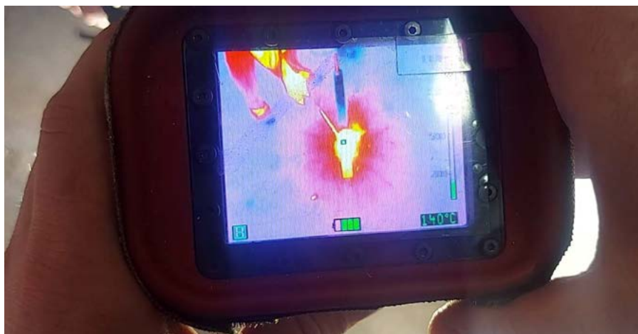
Рисунок 5. Процесс нарастания температуры при сварочной работе
