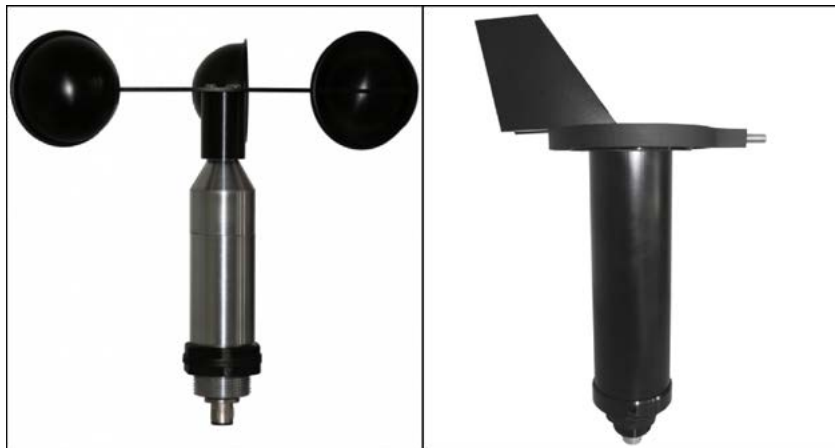
Рисунок 4. Умные датчики, определяющие скорость и направление ветра
