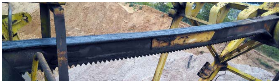
Рисунок 4. Рейка механизма изменения портального крана “Albrecht”
