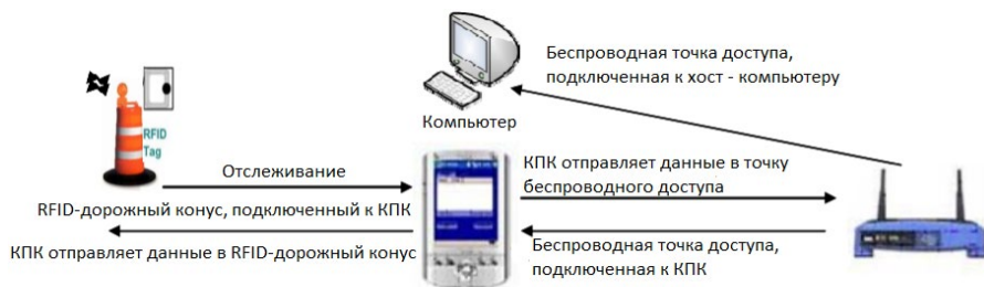
Рисунок 6. Беспроводное соединение между КПК и точкой доступа Wi-Fi.
