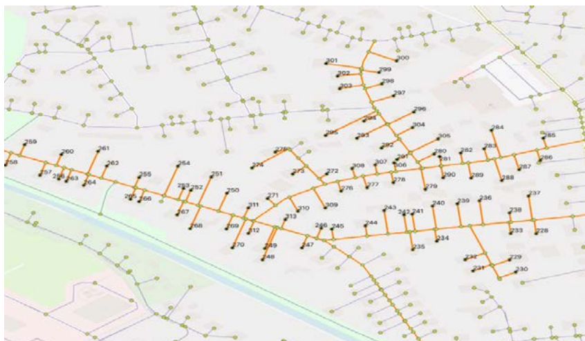
Рисунок 4. Процесс оптимального расстояния прокладки ВОЛС
