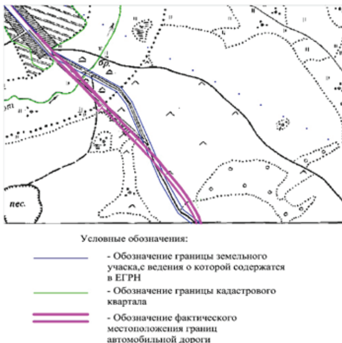
Рисунок 1. Обзорная схема территории, на которой выявлена ошибка в определении местоположения границ земельного участка под автомобильной дорогой
