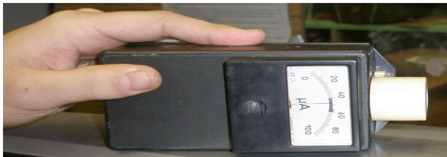
Рисунок 2. Измерение электромагнитной помехи (ЭМП) излучаемой телевизором рядом с корпусом, составляет 45-50 единиц.
